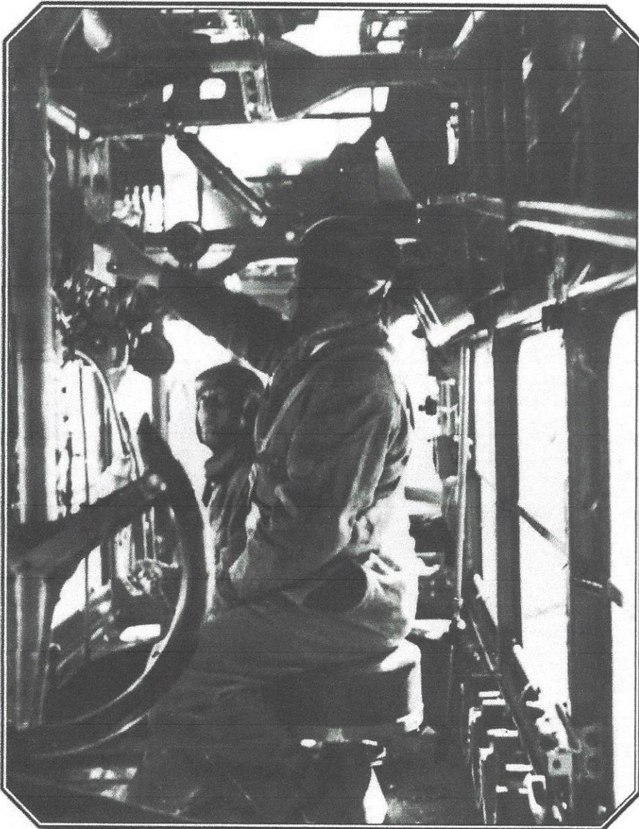
A bord d'un Amiot 143. Il se peut que cette photo montre un instructeur (au premier plan) expliquant à un élève le tableau d'armement des bombes. L'élève tient dans sa main droite le déclencheur des lance-bombe. (SHAA)
